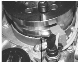
Tacca sul carter / Notch on the crankcase Cran sur le carter / Kerbe auf dem Motorgehäuse Muesca en el carter
